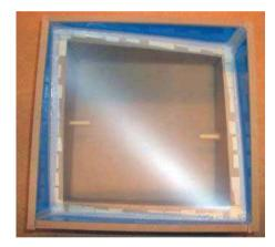
Grondvorm:Tongewelf (dubbel gekromd)Afmetingen:250x250 mmMateriaal:Walopur Platilon U 80μBeschrijving:
