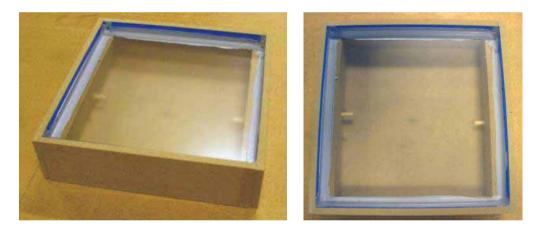
Grondvorm: Afmetingen: Materiaal: Beschrijving: Hypparschaal (dubbelgekromd) 250x250 mm Walopur Platilon U 50µ
